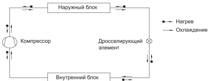
Рисунок 4.2 – Схема работы кондиционера
